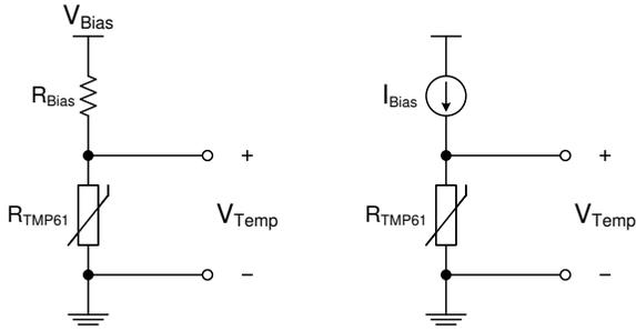
$$V_{Temp} = \frac{V_{Bias} * R_{TMP61}}{R_{Bias} + R_{TMP61}}$$
